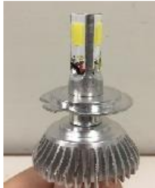
Figura 3 - Led acoplado com dissipador.
