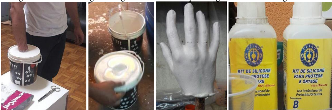
Figura 16 - Aplicação e retirada do silicone
