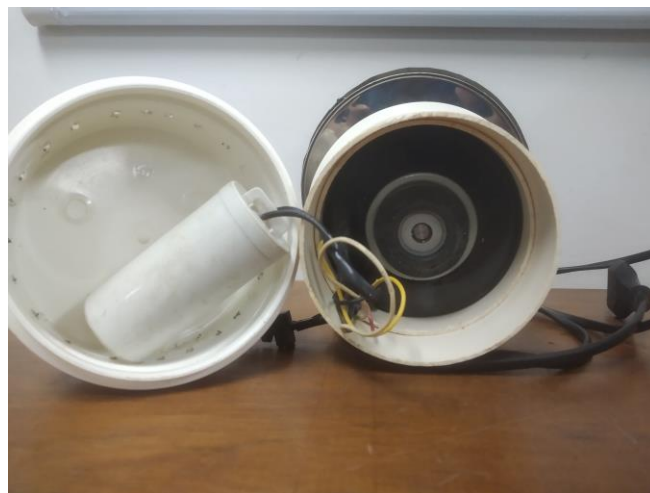
Figura 3 – Conjunto elétrico do motor e o capacitor.
