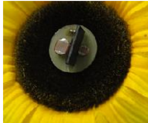
Figura 1 – (a) Robô girassol. (b) Miolo com os sensores LDRs
