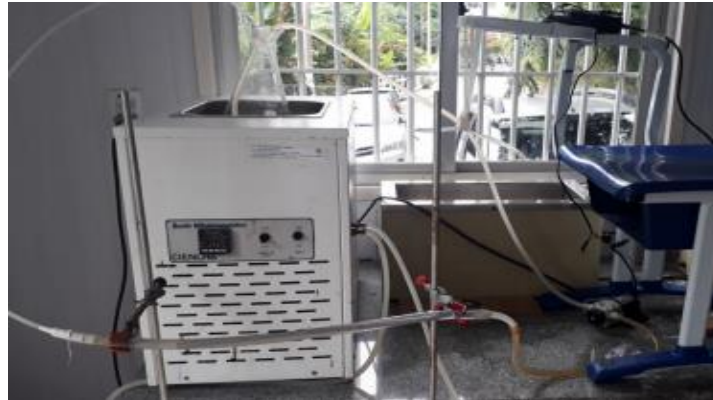
Figura 3: Sistema de circulação da solução com passagem pela seção de aço inox, posicionada na parte frontal do experimento.
