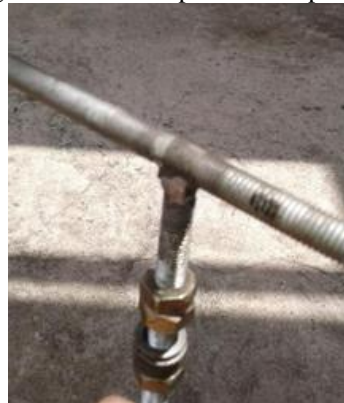
Figura 7- Estrutura para fixar o punção.
