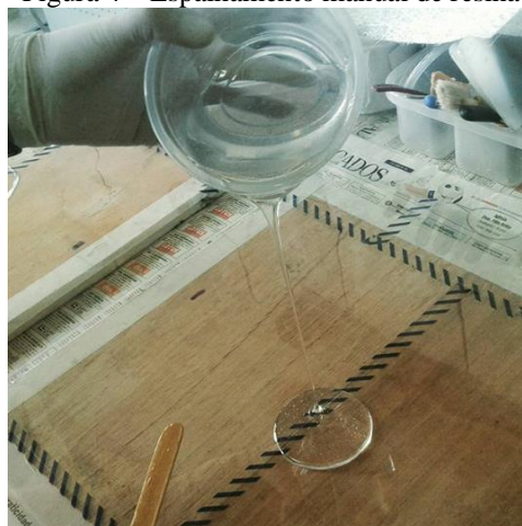
Figura 4 – Espalhamento manual de resina
