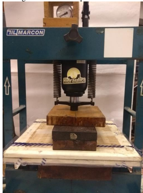
Figura 5 – Molde na prensa hidráulica
