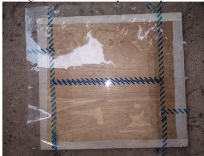
Figura 03– Revestimento da placa de compensado
