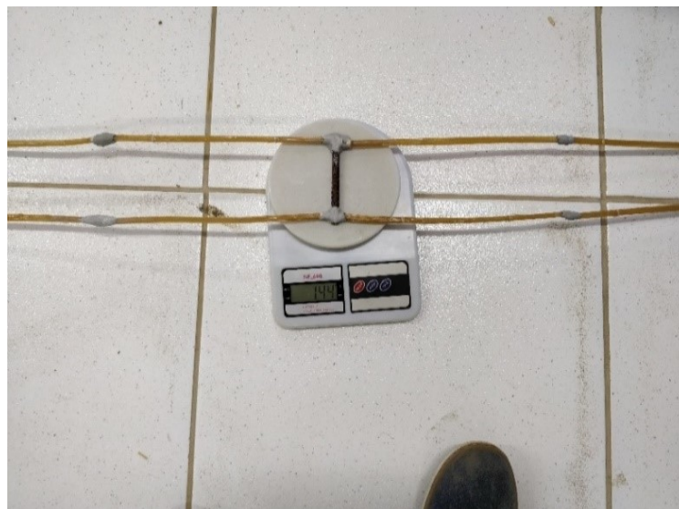
Figura 6 – Pesagem das barras neutras inferiores com a barra de ferro.
