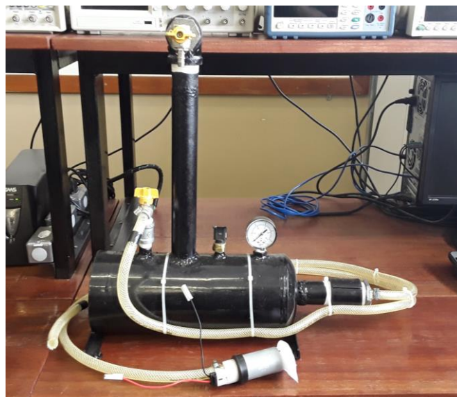
Figura 3 – Vaso de pressão destinado para testes.
