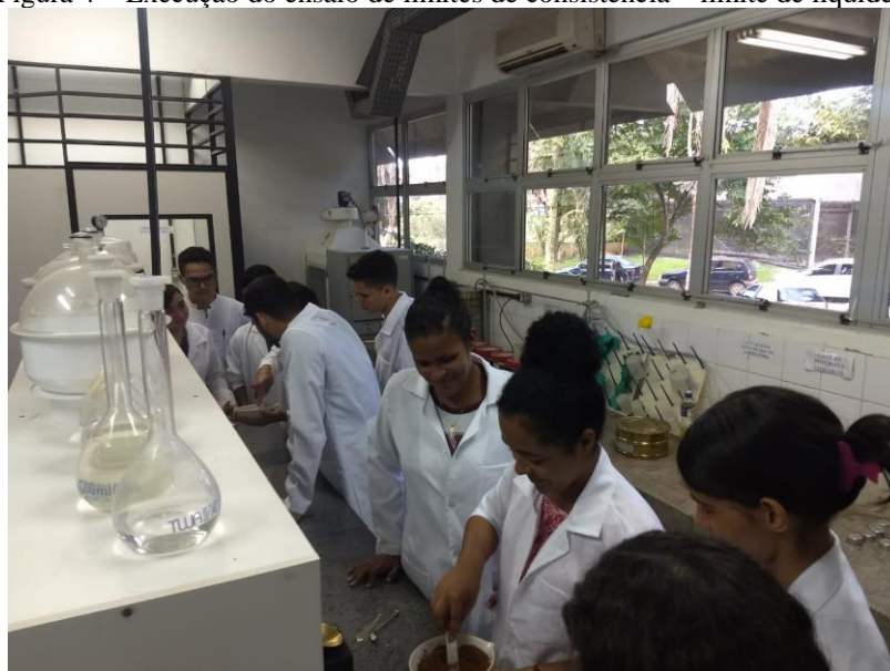
Figura 4 – Execução do ensaio de limites de consistência – limite de liquidez.
