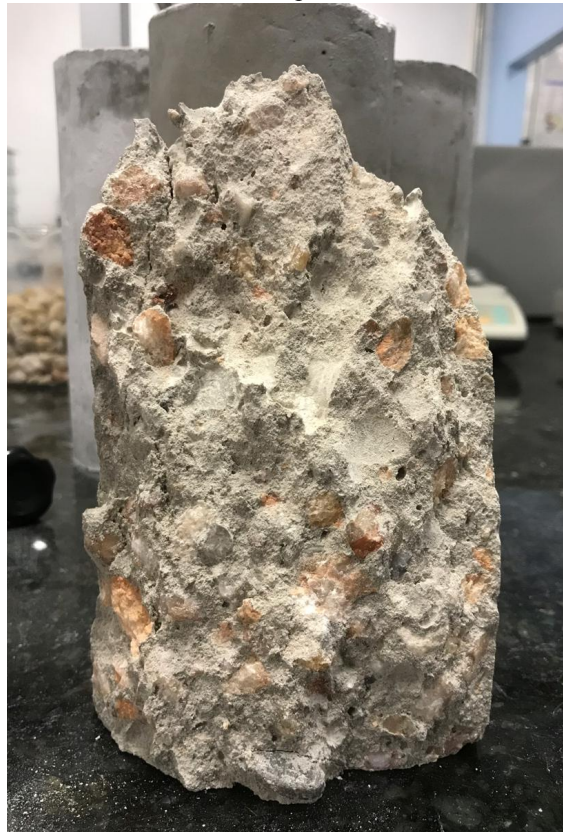
Figura 2 – Corpo de prova de seixo rolado rompido aos 28 dias a resistência à compressão
