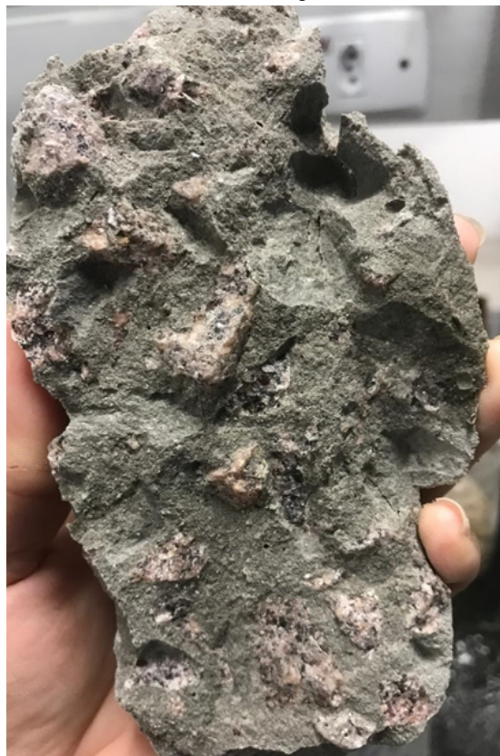
Figura 1 – Corpo de prova de brita granítica rompido aos 28 dias a resistência à compressão
