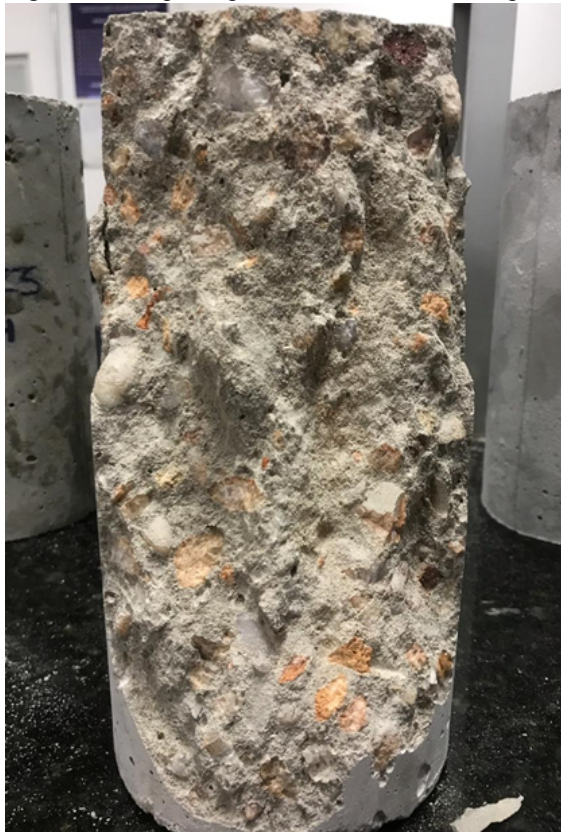
Figura 2 – Corpo de prova de seixo rolado rompido aos 28 dias a resistência à compressão
