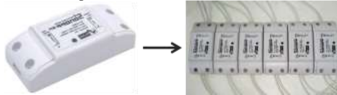
Fig. 6: Sistema de automação utilizando relé Wi-fi Sonoff modelo simples
