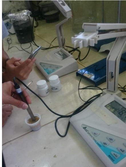
Figura 4- Eletrodo inserido na solução de 25 ml de \text{H}_2\text{O} e 10 g de solo.
