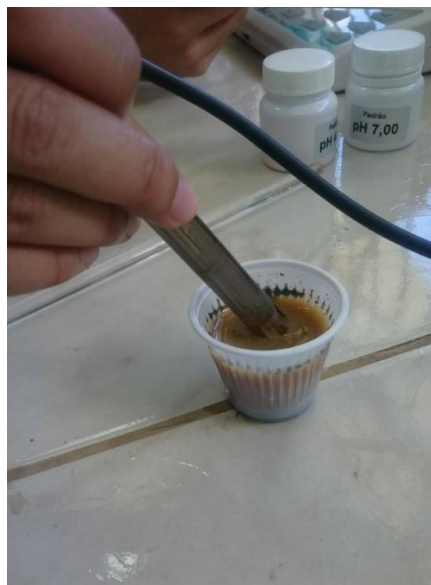
Figura 5- Eletrodo inserido na solução de 25 ml de \text{CaCl}_2 e 10 g de solo.
