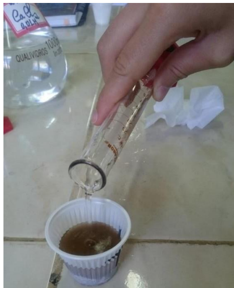
Figura 3- 25 ml de CaCl_2 sendo adicionada ao recipiente com 10g de solo
