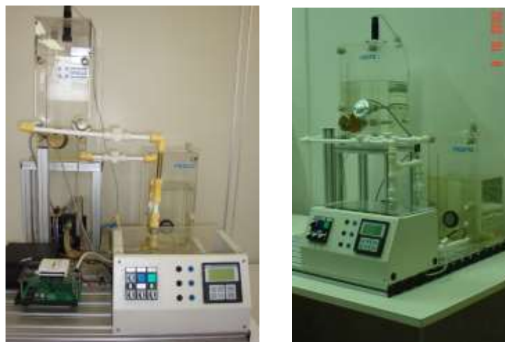
Figura 1 – Planta de Controle de Nível – PCS Festo.
