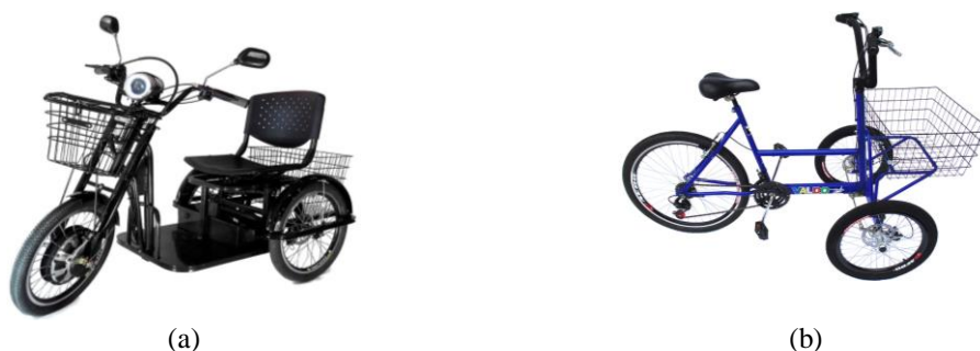
Figura1 – (a) Triciclo com tração e direção dianteira e roda dupla traseira; (b) Triciclo com roda dupla na direção dianteira e tração traseira.
