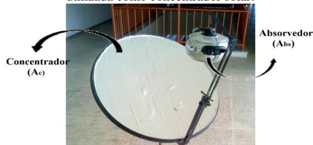
Figura 2 – Antena parabólica utilizada como concentrador solar.
