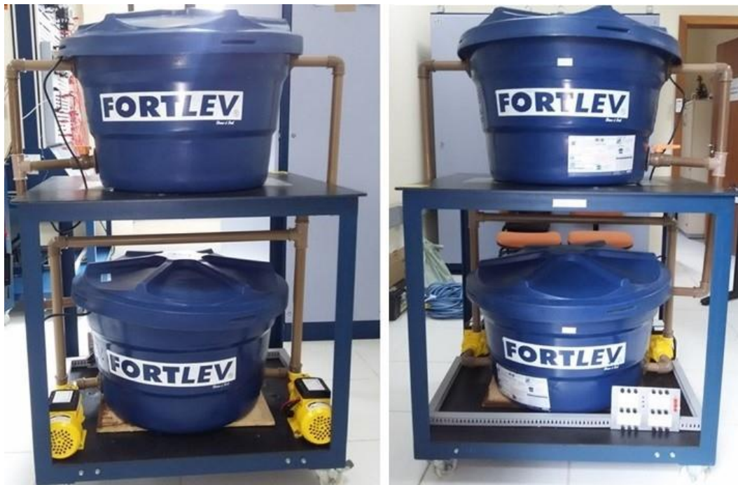
Figura 4 – Vista posterior e frontal do protótipo de bombeamento de água, respectivamente
