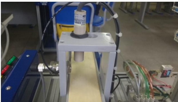
Figura 3 – Arranjo dos sensores na esteira
