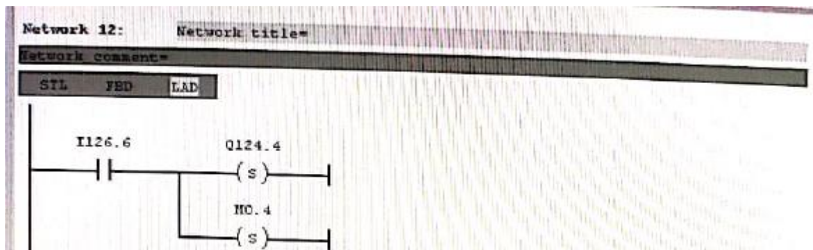
Figura 10: Atuação da garra na posição avançada de Y
