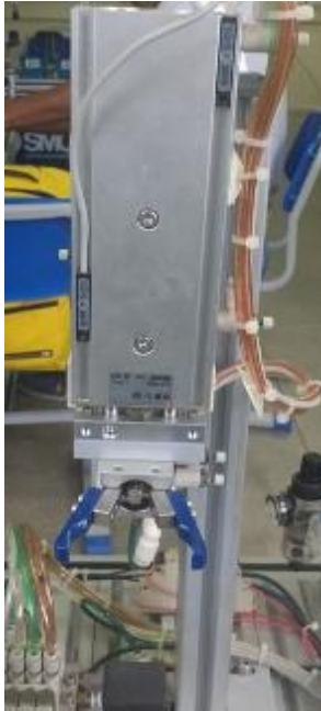
Figura 5 – Garra pneumática para transferência de peça para planta 2.
