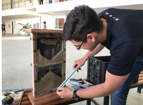
Figura 6 - Cálculo de ângulo e volume da pilha
