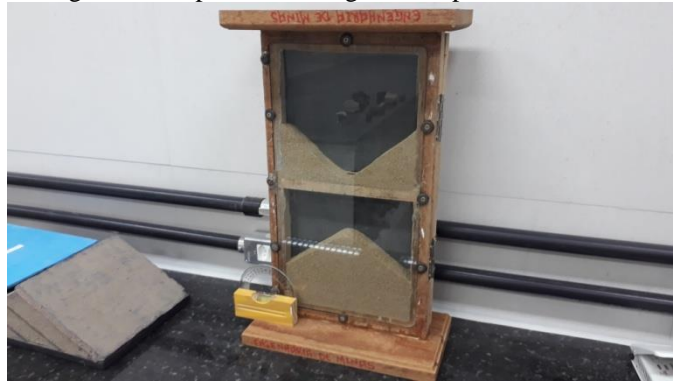
Figura 2 - Dispositivo de ângulo de repouso de minério
