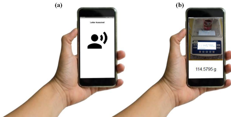
Figura 4 – Representação da tela (a) inicial e (b) em uso do aplicativo com reconhecimento da balança analítica disponível.
