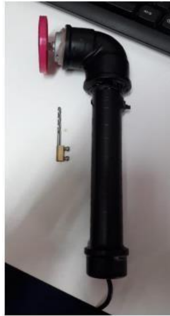
Figura 4- Ferramenta transformada em mini retífica.
