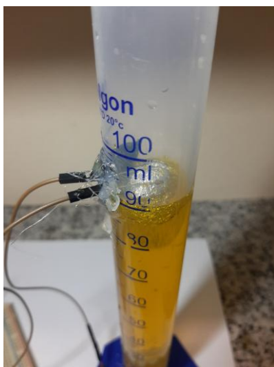
Figura 6 - Detecção do volume, neste exemplo o desejado é 90mL: (a) por material de isopor revestido com papel alumínio fechando contato para o buzzer e (b) vista superior do sistema.
