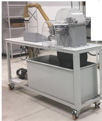
Figura 3 - Bancada Pelton utilizadas em instituições parceiras.
