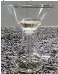
Figura 8 – Filtragem dos ácidos graxos para remoção de sal
