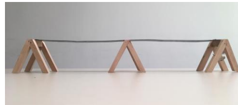
Figura 7 – Viga para estudo de deflexão com deslocamento de apoio.
