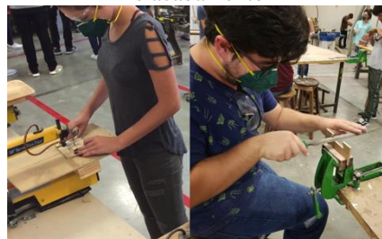
Figura 6 – Atividade “rabo de andorinha” – Corte e acabamento
