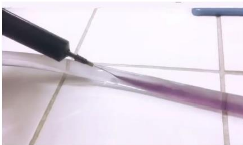
Figura 3 - Regime turbulento, onde Re > 2400 .
