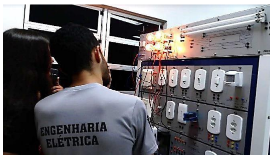
Figura 5 – Exemplo de montagem do circuito paralelo.
