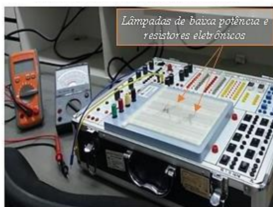
Figura 2 – Maleta experimental, protoboard e dispositivos periféricos.
