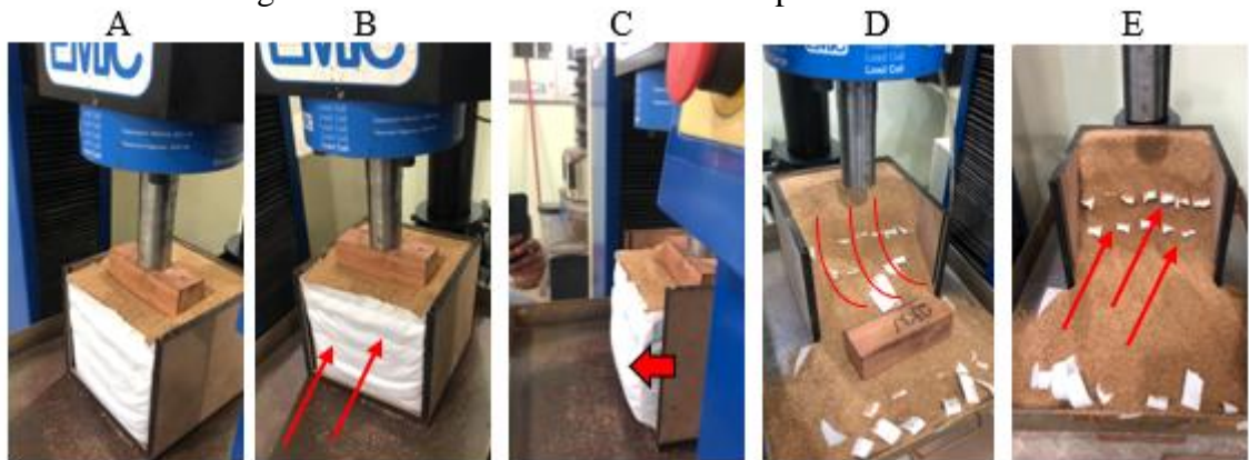
Figura 4 – Ensaio de resistência à compressão axial
