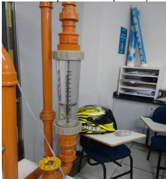
Figura 5: Rotâmetro: aparelho utilizado para medição de vazão
