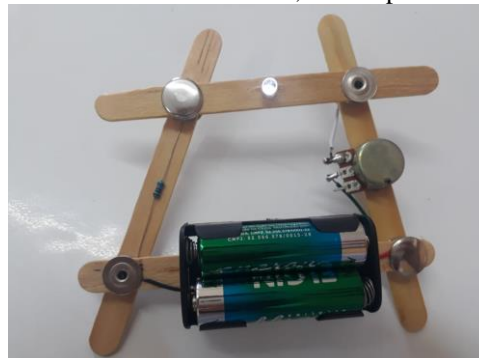
Figura 11: Circuito com resistor, LED e potenciômetro.
