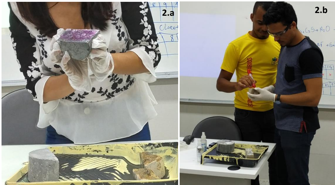
Figura 2 – Atividade em sala de aula com corpos de prova de concreto (a. Aspersão de fenolftaleína e b. discentes realizando as medidas de frente de carbonatação)
