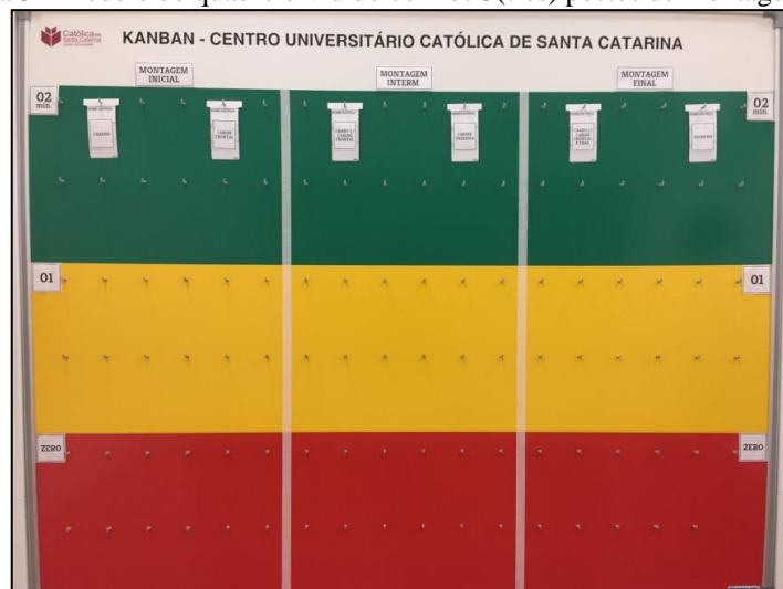
Figura 3 - Modelo do quadro dividido com os 3(três) postos de montagem.
