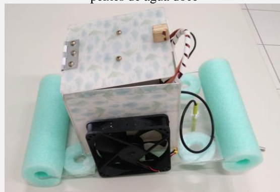
Figura 3 – Aerotech – Aerador para açudes de peixes de água doce
