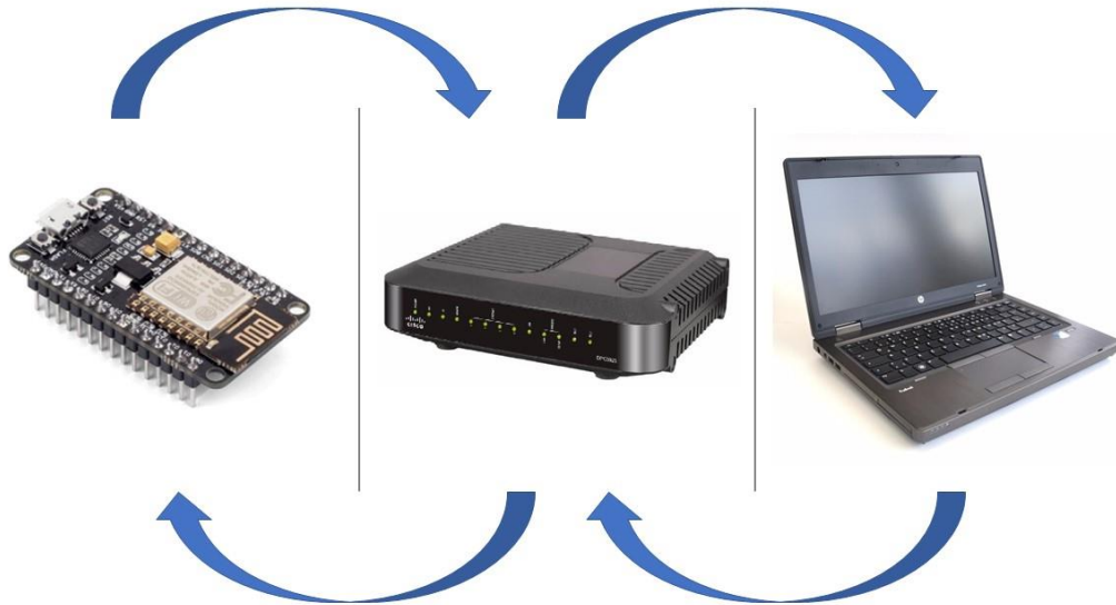
Figura 2 - Fluxo de dados entre os dispositivos que utilizam o DAQWiFi.
