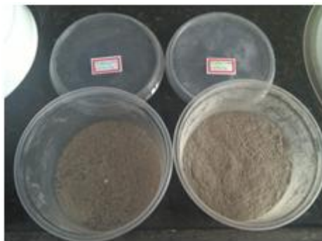
Figura 3 – Material passante e material retido das cinzas do carvão vegetal.
