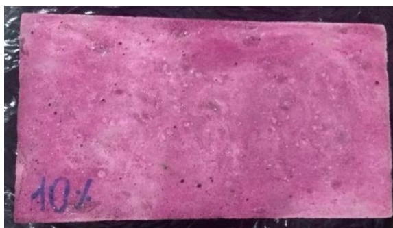
Figura 9 – Amostra sobre presença de óleo penetrante e revelador contendo 10% de calcite
