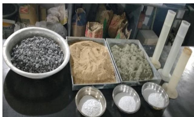
Figura 2 – Materiais: cimento, areia, brita, água e calcite.
