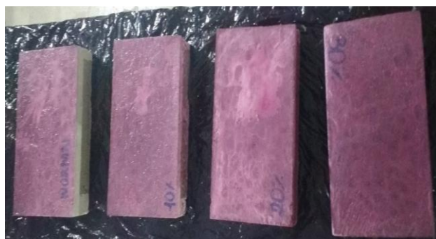
Figura 18 – Óleo Penetrante aplicado nos moldes de concreto
