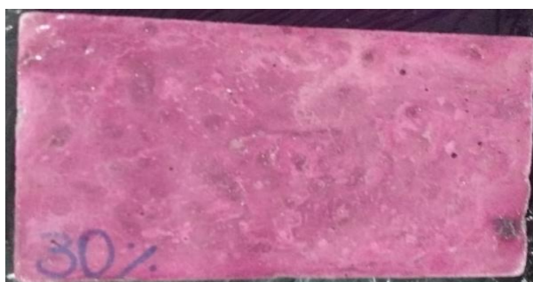
Figura 11 – Amostra sobre presença de óleo penetrante revelador contendo 30% de calcite
