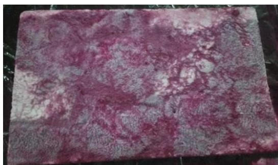
Figura 19 – Amostra sem presença de calcite
