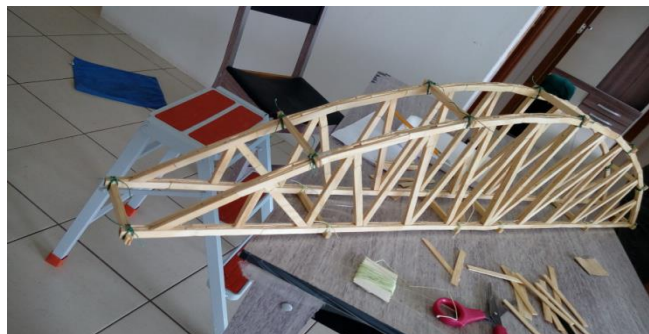
Figura 5- Processo de junção das treliças.
