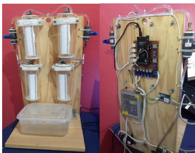
Figura 1 - Planta de quatro tanques de nível
