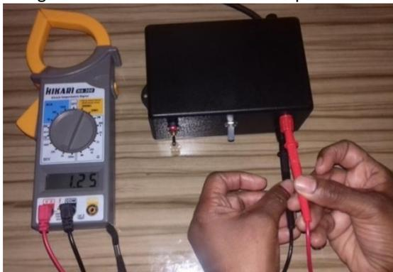
Figura 8: Tensão máxima fornecida pela fonte
