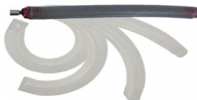
A bexiga interna do silicone age como um balão, que quando inflado ele se expande em todas as direções. Porém com uma base rígida é possível com que o silicone se expanda de forma uniforme, realizando assim o movimento desejado.
