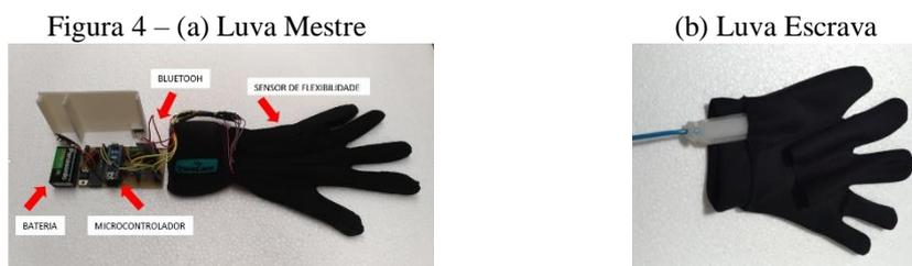
Nestas luvas, o sensor de flexibilidade indicou 30(1)k $\Omega$  sem dobra dos dedos e 70(1)k $\Omega$  com dedos dobrados em 90°. Apresentando funcionamento adequado para acompanhamento das flexões.
