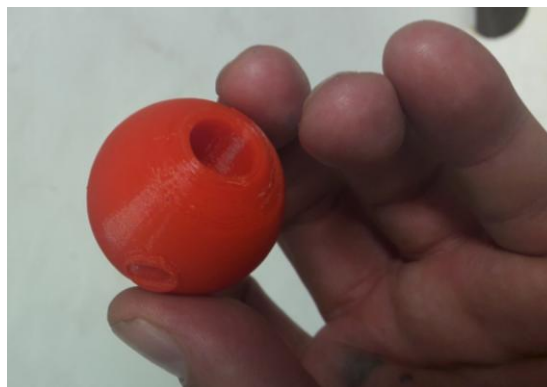
Figura 15: Detalhe da impressão do encaixe do átomo de Oxigênio
