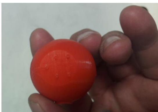
Figura 14: Detalhe da impressão do código Braille do átomo de Oxigênio
