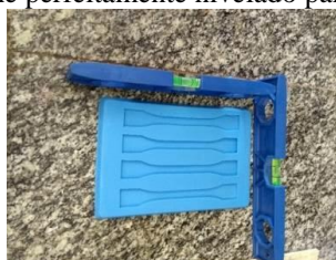
Figura 12 – Molde de silicone perfeitamente nivelado para o vazamento do compósito.
