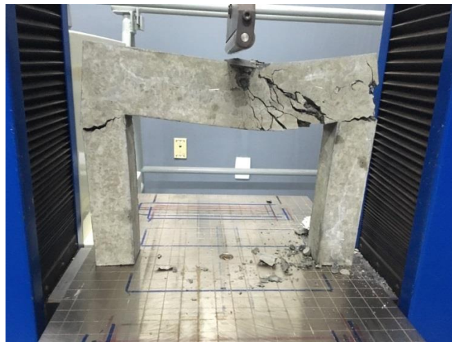
Figura 3 – Viga fissurada e rompida
