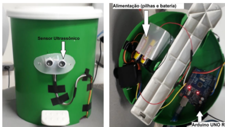
Figura 3: Vista frontal da lixeira e dos componentes elétricos
