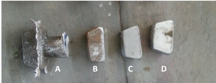
Figura 6 – Peças finais obtidas pela fundição
