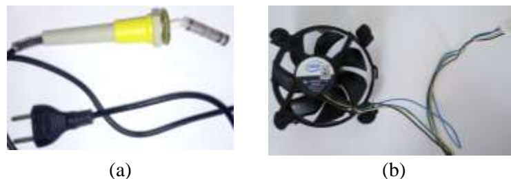
Figura 3 – (a) Resistência de aquecimento e (b) cooler 12V.
