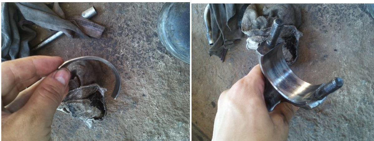
Figura 2 – Peças defeituosas no automóvel: (a) bronzina danificada, (b) biela desbastada.
