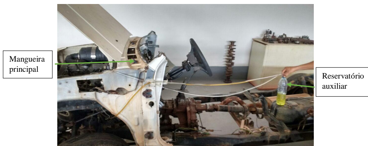
Figura 10 – Simulação de um defeito na bancada.
