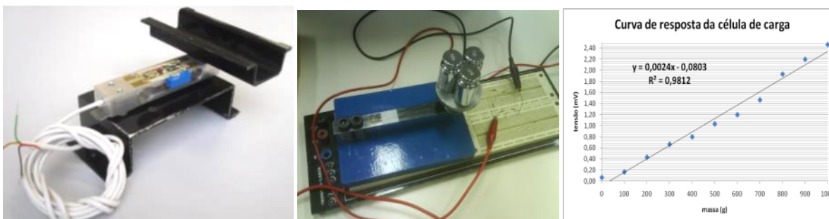
Figura 7 - Montagem e calibração das células de carga
