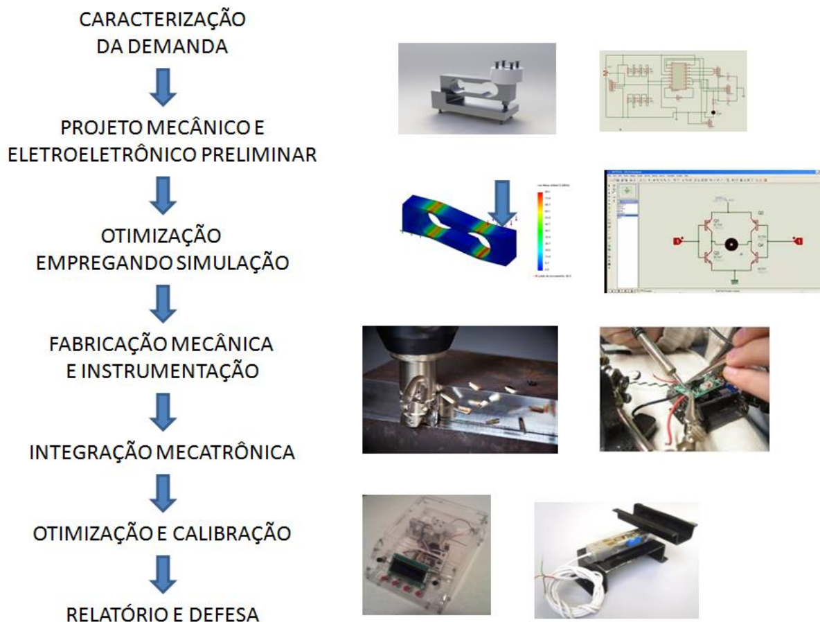
Figura 4 - Demandas tecnológicas no projeto, construção e operação de uma célula de carga
