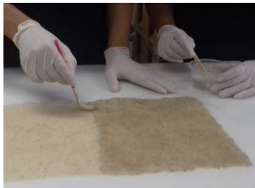
Figura 16 – Aplicação da laminação manual
