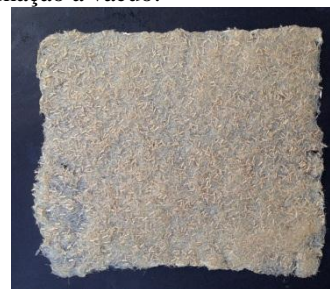
Figura 17 – Placas produzidas no desenvolvimento da metodologia ensinada aos alunos. (a) Placa feita por infusão a vácuo, (b) Placa feita por laminação a vácuo.
