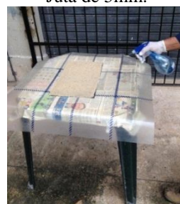
Figura 15 – Pulverização de resina sobre manta de Juta de 5mm.
