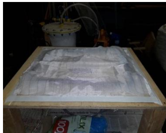
Figura 17 – Processo de infusão a vácuo aplicado à manta de juta
