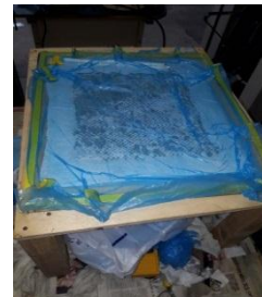
Figura 17 – Processo de infusão a vácuo aplicado à manta de juta
