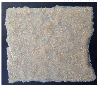
Figura 17 – Placas produzidas no desenvolvimento da metodologia ensinada aos alunos. (a) Placa feita por infusão a vácuo, (b) Placa feita por laminação a vácuo.
